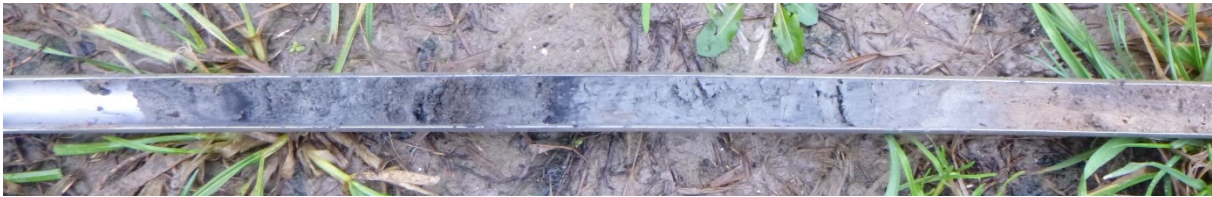
Figuur 7: Het pakket venige klei dat op boorpunt 58 rond 5 meter -NAP is aangetroffen.
