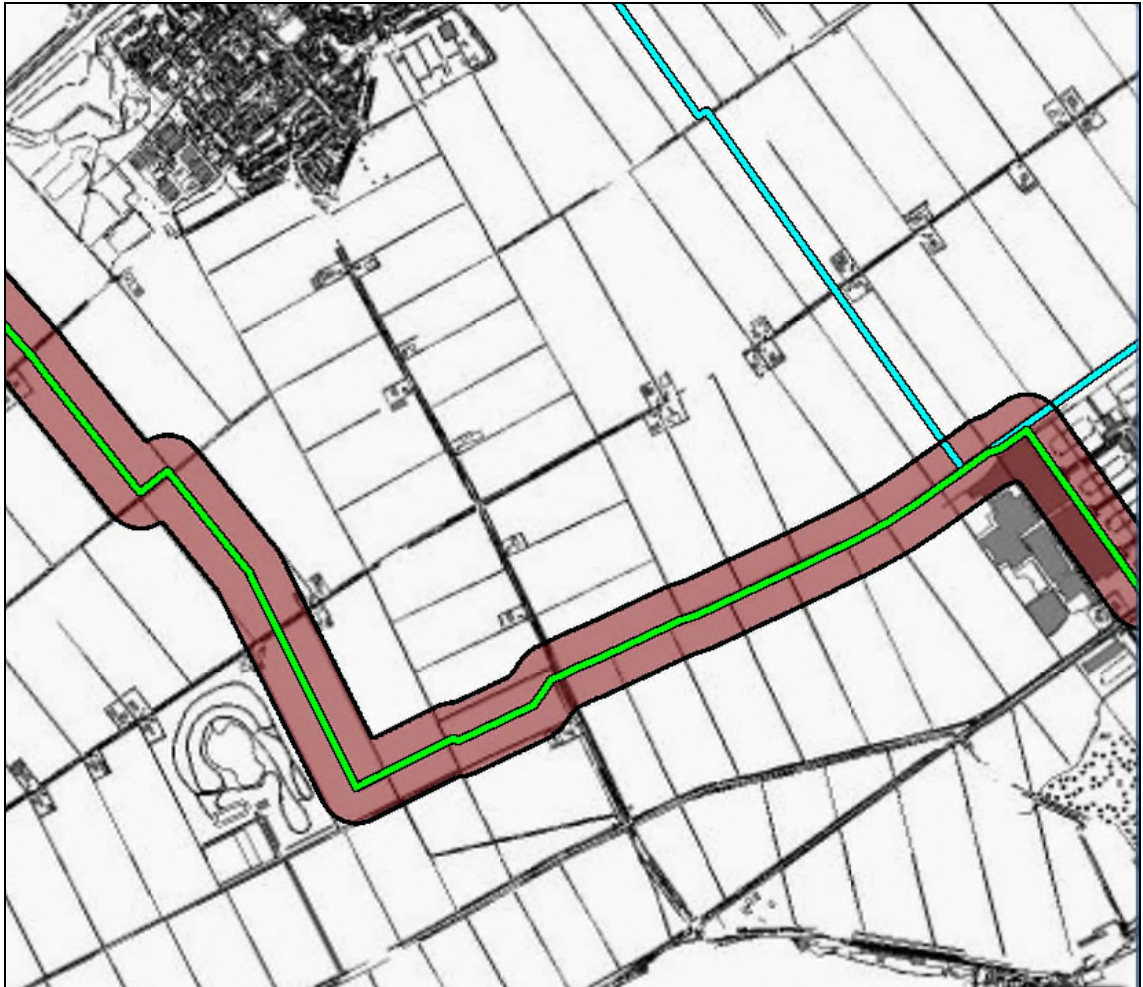
Figuur 4.9b Invloedsgebied gasbuisleiding A-570 oostelijk deel
