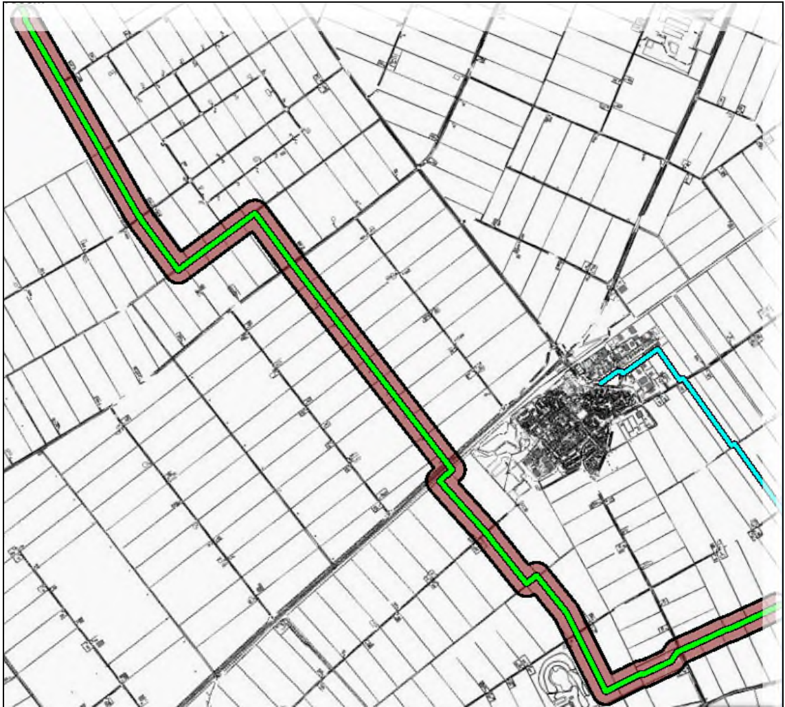
Figuur 4.9a Invloedsgebied gasbuisleiding A-570 westelijk deel
