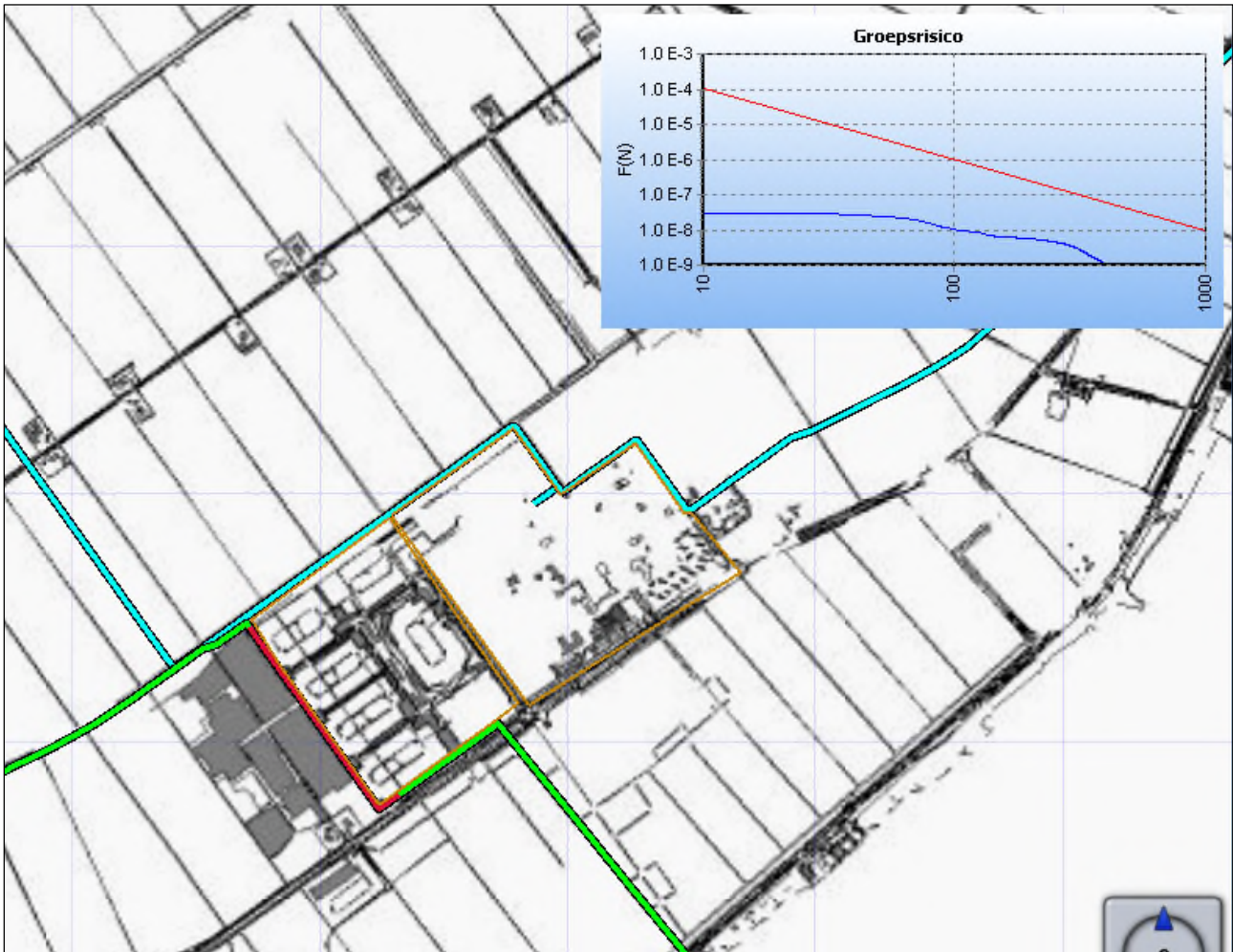
Figuur 4.9c Resultaat groepsrisicoberekening: groepsrisicocurve en ligging km met maximaal groepsrisico (rode lijn)
